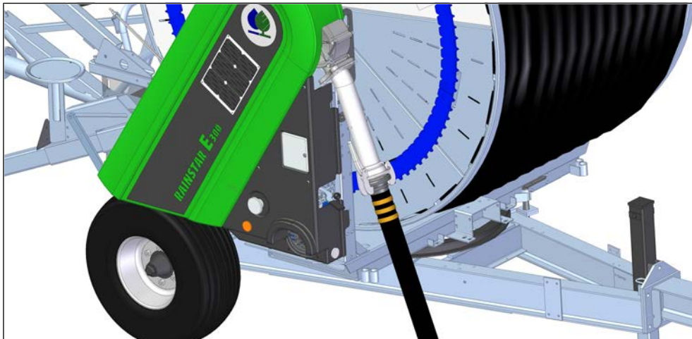
Abb. 27: Druckschlauch ankuppeln
